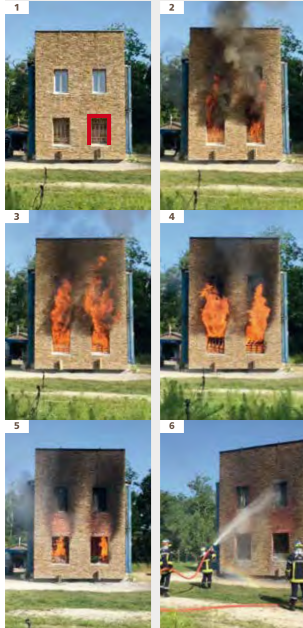
Das garantierte murogeopietra Verfahren auf EPS bewahrt die Festigkeit der Fassade.
