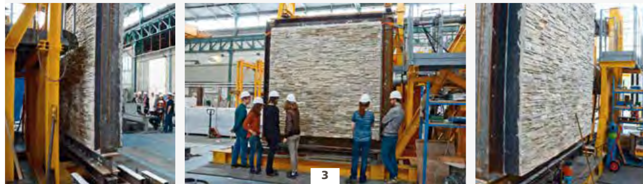
muregeopietra auf Betonbausteinen
