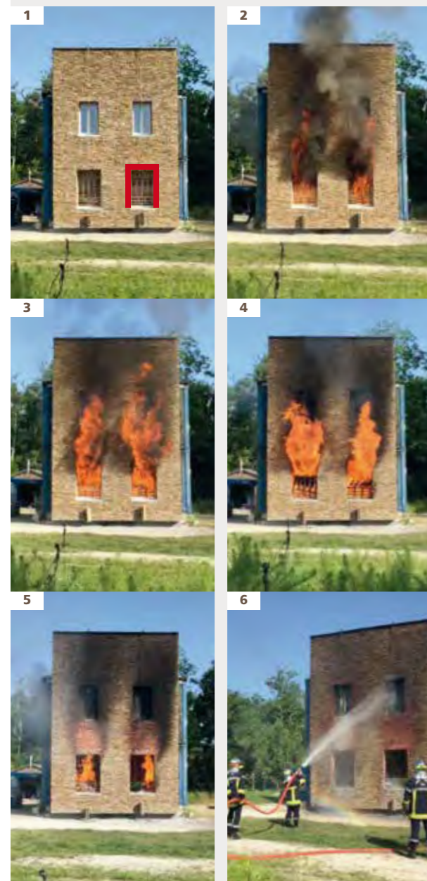
De gewaarborgde Murogeopietra-installatie op EPS behoudt de stevigheid van het gevel oppervlak.
